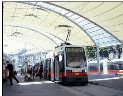
Moderne lavgulvsvogn med indstignings- og gulvhøjde på kun 20 cm, holder på en ny letbaneterminal i Wien.
