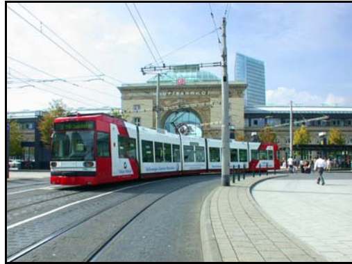
Egen åben tracé ved Mannheims banegård.
